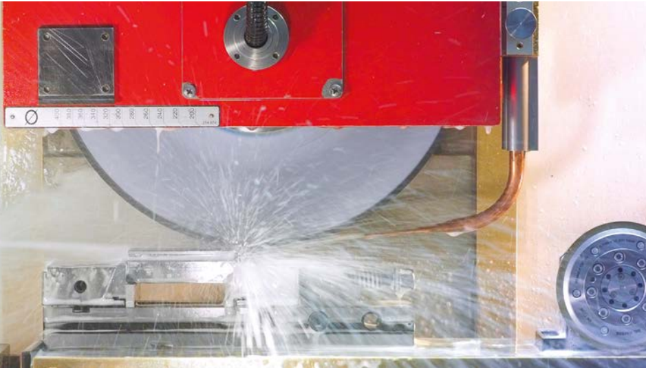
Die einzelnen Schleif- und Abrichtkomponenten des Systemanbieters DR. KAISER ermöglichen ein optimales Zusammenspiel, wie hier beim Flachsleifen.
